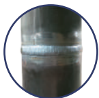
การเชื่อมชน (Welding)
